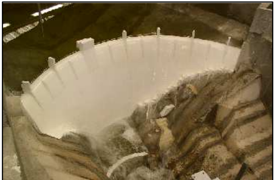
Modello idraulico della diga
